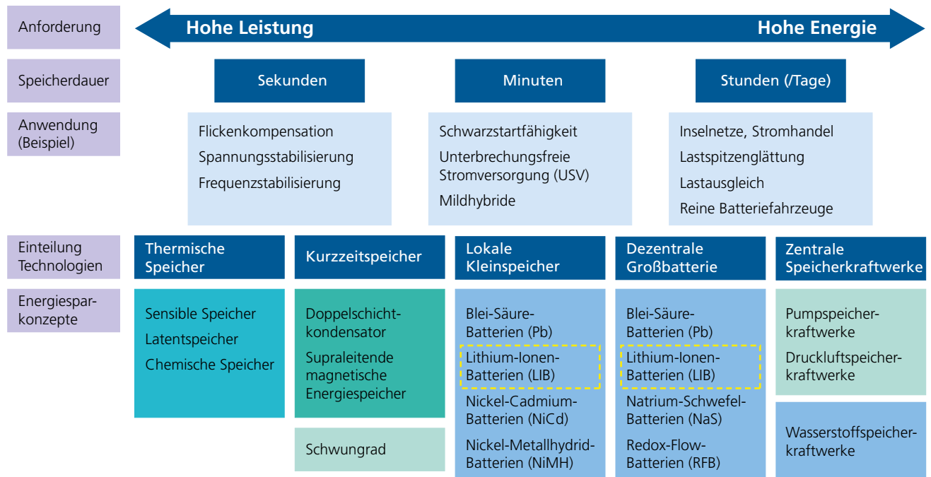
Abbildung 1: Klassifizierung gängiger Energiespeichertechnologien 1
