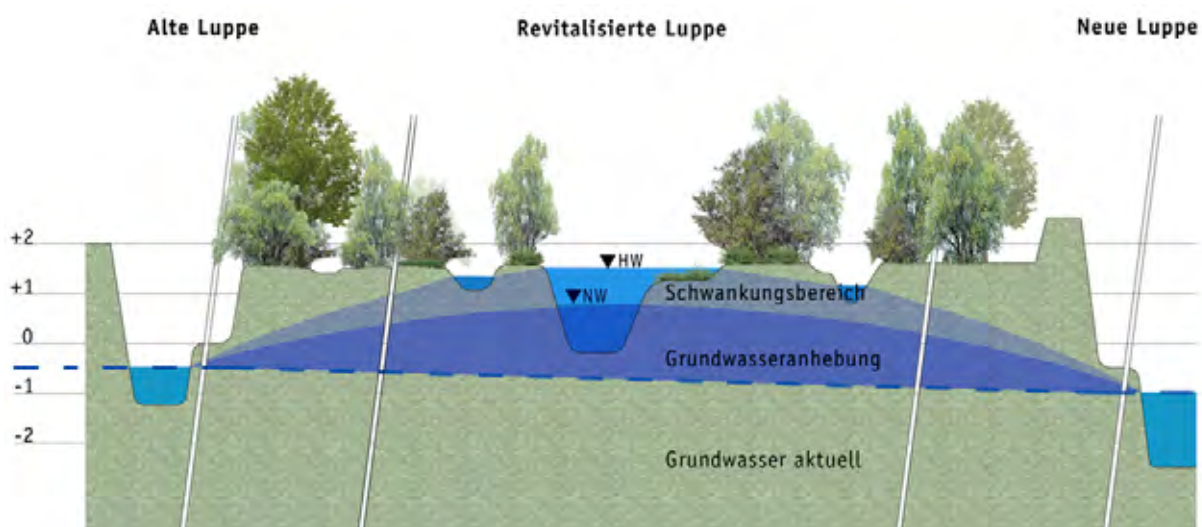
Abb. 2: Entwicklungsziel: intakter Wasserhaushalt im Elster-Luppe-Auwald
