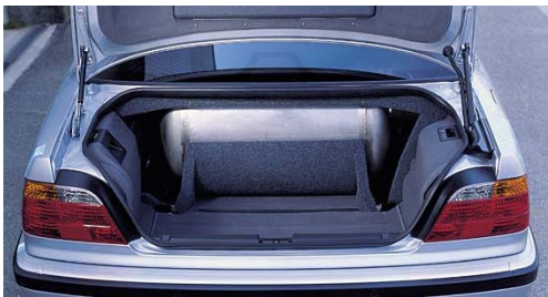
Bild 4: Kryogener Wasserstofftank hinter Rückbank (Quelle: BMW)
