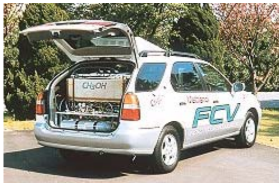
Bild 74: Nissan R'nessa FCV mit Brennstoffzellensystem im Kofferraum (Quelle: Nissan)
