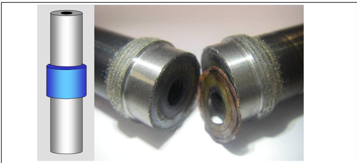
Wie erwartet, kam es aufgrund der Sprödigkeit zu relativ großen Schwankungen der Messwerte. Es genügen hier bereits kleinste Kerben, um die Probe zu Bruch zu bringen. Die in Tab. 2 angegebenen Werte sind daher als Maximalwerte zu betrachten.
