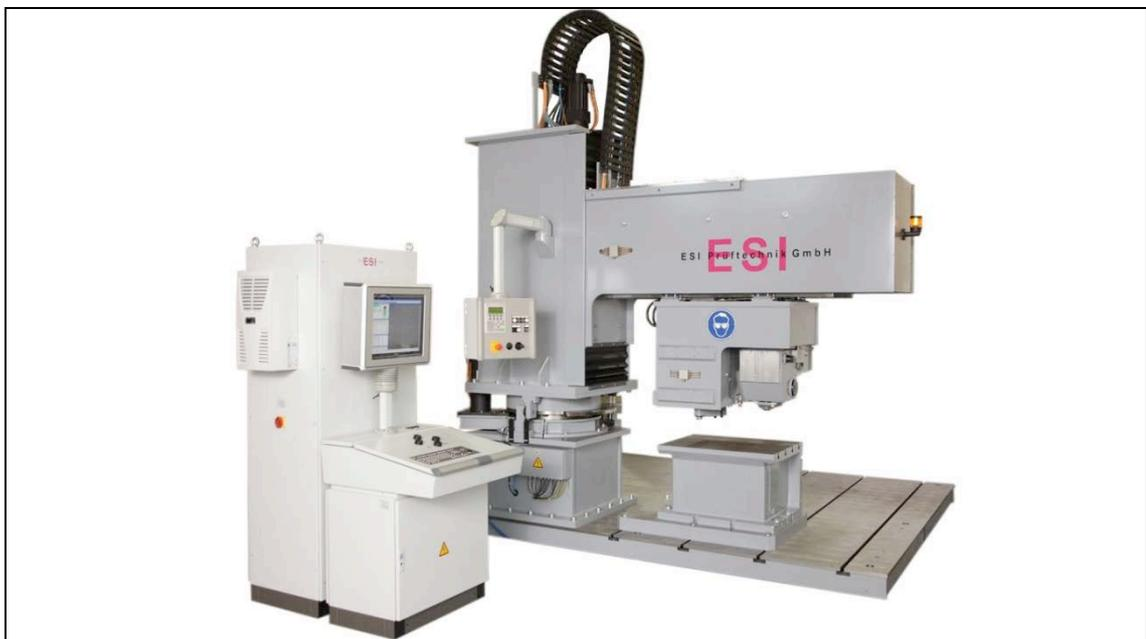
Automatische Brinellprüfmaschine EBRF 3000 von ESI mit integrierter Probenfräse und bis zu 3to Prüfkraft (mit freundlicher Genehmigung der Fa. ESI)
