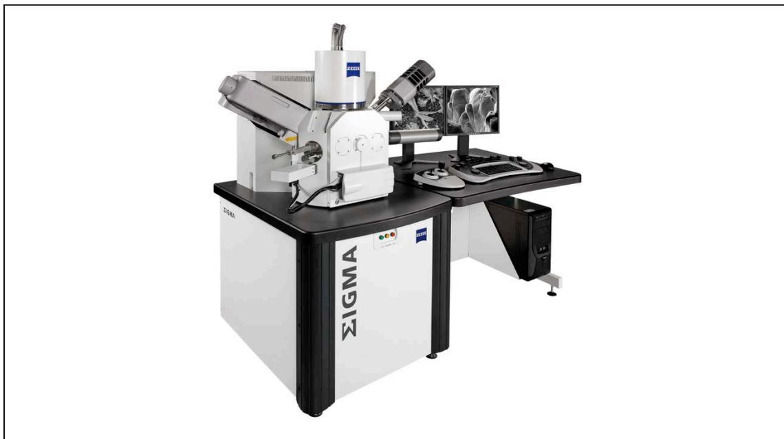
FE-REM von Zeiss mit angeflanschten Analytikdetektoren, EDX, WDX, und EDSD von Oxford (mit freundlicher Genehmigung der Karl Zeiss SMT AG)
