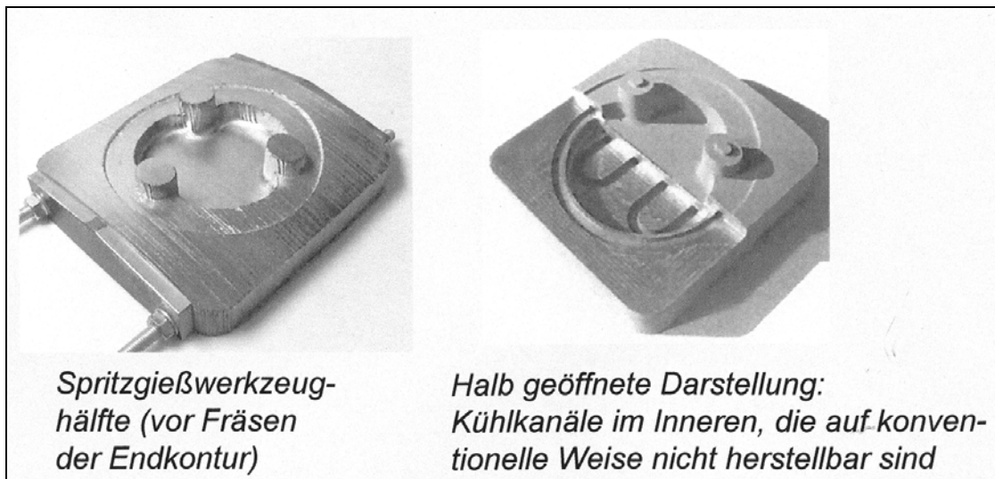
Abbildung 6 Hohlkonturen (Kühlkanäle) in einem laminierten lasergeschnittenen Werkzeug
