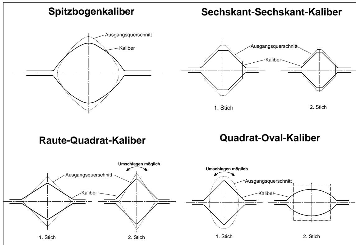
Die besten Resultate wurden mit der Verwendung von Sechskant-Sechskant-Kalibern erreicht. Diese Geometrie zeichnet sich dadurch aus, dass kein Umschlagen des geformten Drahtes möglich ist und dieser sich nicht verdrehen kann.
