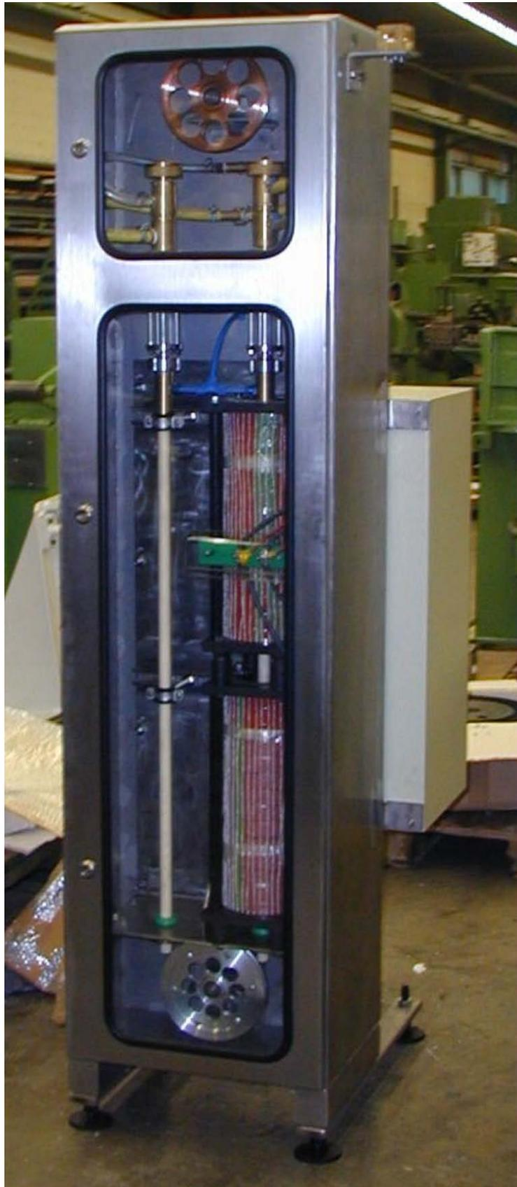
Der Einsatz dieses Prinzips bietet sich insbesondere für Materialien mit höherem Widerstand im kleinen und mittleren Abmessungsbereich an. Ebenfalls möglich ist die Glühung von Flach- und Profildrähten, da die Kontaktierung immer nur auf einer Bandseite erforderlich ist. Ein weiterer Vorteil ist der einfache Anlagenaufbau bei deutlicher Reduzierung der Verschleißmöglichkeiten und Verschleißteile.
