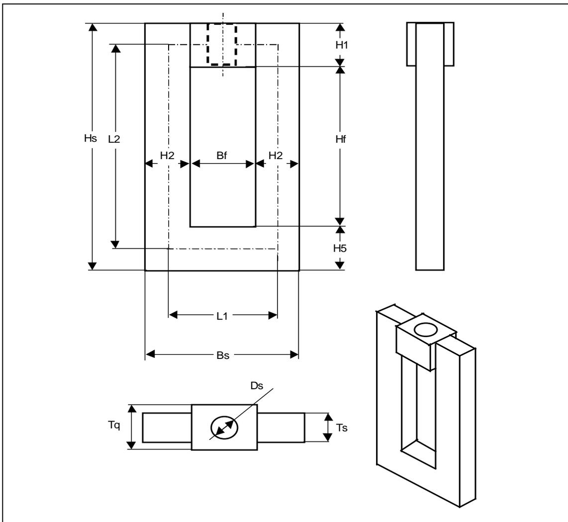
Unter Berücksichtigung der geometrieabhängigen, in Tabellen hinterlegten Formzahlen für Bohrungen und Fensterecken werden die aus der Belastung resultierenden Ständerdehnungen berechnet und in Abhängigkeit der Belastung grafisch dargestellt (Abbildung 2).
