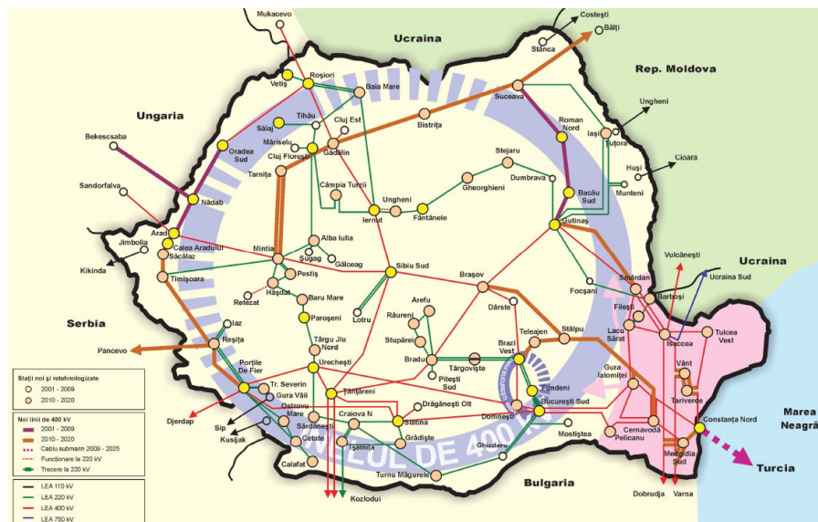
Figura 12. Rețeaua națională de transport al energiei electrice
