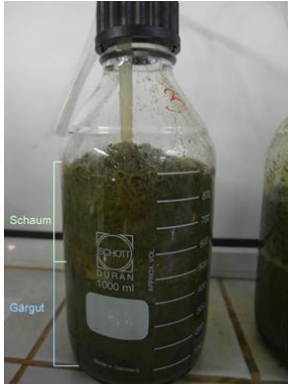
Abbildung 26: Versuch zur Ermittlung der Ursache der Schaumbildung in der Biogasanlage „Nawaro 8“: Schaumbildung nach Zugabe von 4,7 % (w/w) Triticaleschrot zu einem aktiven Gärmaterial aus der Biogasanlage „Nawaro 10“.
