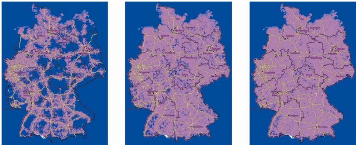
Abb. 1: Die Entwicklung des Mobilfunknetzes des Netzbetreibers D1 (Deutsche Telekom) in Deutschland in den Jahren 1992, 1996 und 2000
