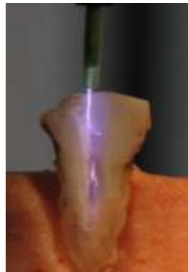
Präparierter menschlicher Zahn – Plasma Filament im Wurzelkanal
