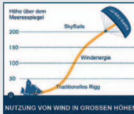
SkySails Systemkomponenten und die Nutzung von Wind in großen Höhen (© SkySails)
