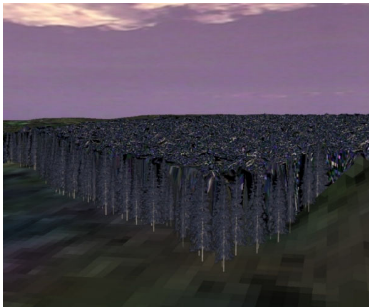
Abb. 18: TIN mit eingerechneter Vegetationshöhe, überlagertem Fusionsbild und Billboard -Bäumen im Vordergrund
