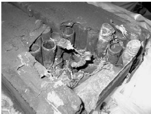
Abb. 24: Batteriebrand und –explosion verursacht durch Thermal Runaway [Beau08, S.9]
