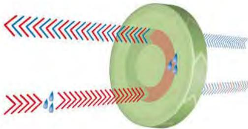
**Abbildung 22:** Rotationswärmetauscher<sup>15</sup>
