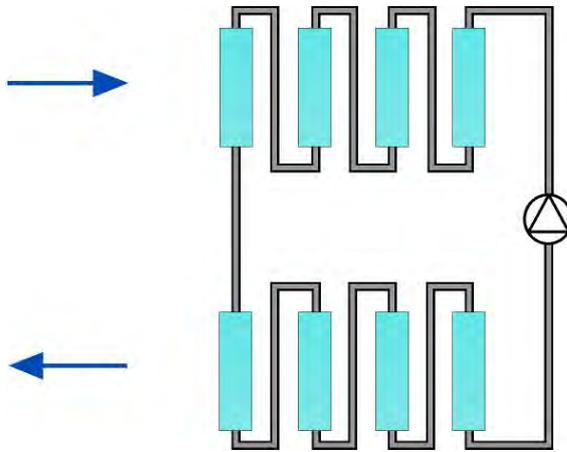
**Abbildung 23:** Kreislaufverbund Wärmetauscher<sup>20</sup>
