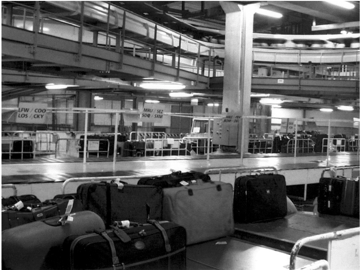
Anlage für automatische Gepäcksortierung, Paris-Roissy.
