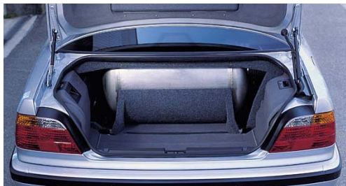
Bild 4: Kryogener Wasserstofftank hinter Rückbank (Quelle: BMW)
