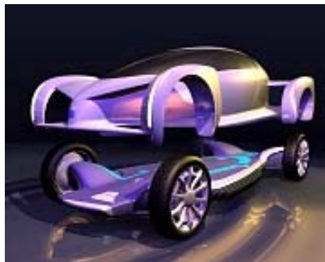
Bild 48: „Skateboard“ und Karosserie der Fahrzeugstudie „AUTOnomy“ (Quelle: GM)
