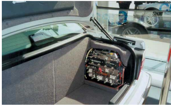
Bild 6: Brennstoffzellen APU im BMW 750 hL (Quelle: UTC Fuel Cells)
