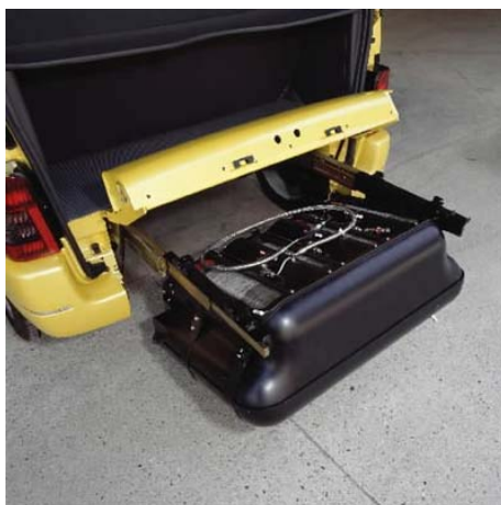
Bild 71: Wasserstofftank des Taxi PAC (Quelle: Peugeot)
