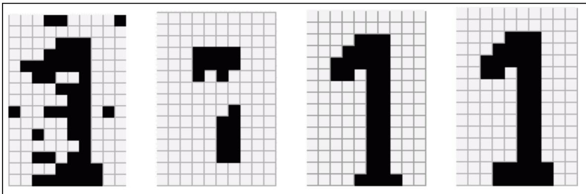
Die Abbildung zeigt die Wiedererkennung eines Musters. Das Hopfield-Netz besteht aus 10x15 Neuronen. Die Eingabe ist verrauscht, das System erkennt in drei Schritten das Muster. Das Muster der Zahl 1 ist eines von mehreren Mustern, welches dem Netz vorher eingeprägt wurde.
