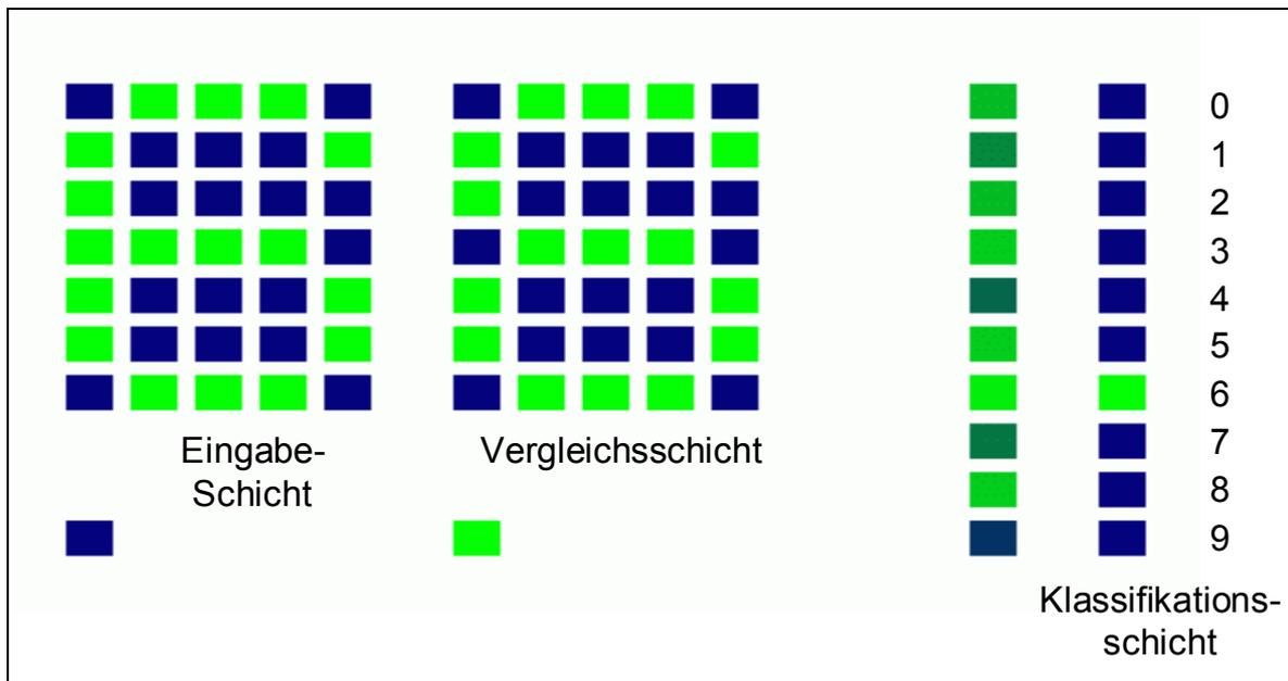
Im Unterschied zu einer selbstorganisierenden Karte kann der Benutzer eines ART-Netzes die Klassifikation oder besser Clustering besser steuern. Die maximale Zahl von Klassen kann durch die Größe der Klassifikationsschicht vorgegeben und die Gruppierung durch die Wahl des Ähnlichkeitsparameters direkt beeinflusst werden.
