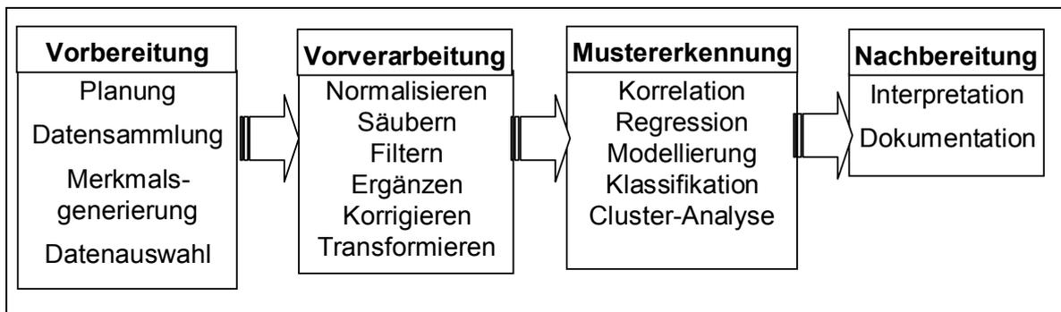
Abbildung 1 spiegelt dabei nur den sequentiellen Ablauf der vier Etappen wider, der in dieser Form nur nach vielen Experimenten durchlaufen werden kann. Ähnlich wie der Prozess der Software-Entwicklung ist auch das Extrahieren von Wissen aus einem Anwendungsfall ein eher zyklischer Prozess. Abbildung 2 verdeutlicht diese Sichtweise.
