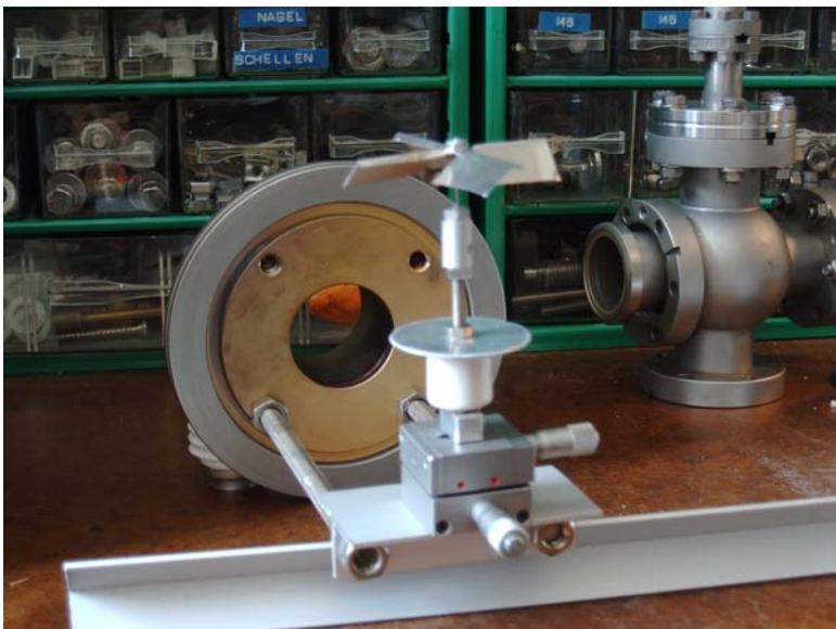
Die im Bild zu sehende xy-Mimik ist noch nicht in-situ bei im Vakuum montierten Rotor zu verstellen, wurde aber im weiteren Verlauf der Experimente durch eine von außen bedienbare xy-Mimik mit zwei Vakuumdurchführungen ersetzt, die bedient werden konnte während der Rotor im Vakuum war.
