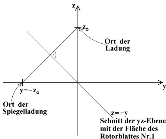
**Abb. 7:** Skizze zur Auffindung der Position der Spiegelladung. Sowohl die Ladung  $q$  als auch die Spiegelladung  $q'$  tragen die  $x$ -Koordinate  $x=0$ . Deshalb genügt der zweidimensionale Schnitt der  $yz$ -Ebene zur Konstruktion der Lage der Spiegelladung. Dabei wird die Position der Ladung  $q$  am Schnitt des Rotorblattes Nr.1 gespiegelt.
