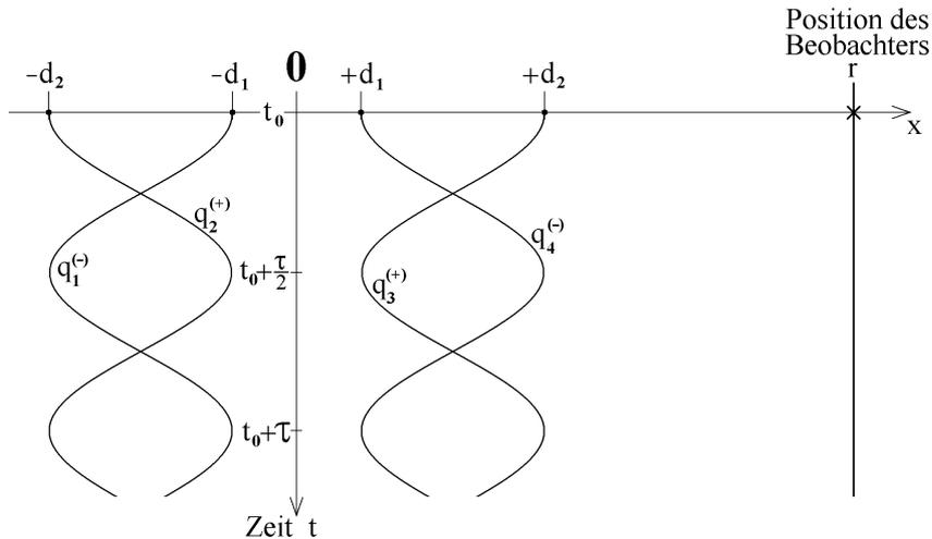
**Abb. 1:** Darstellung der Schwingungen der vier Ladungen als Funktion der Zeit, wie sie als Vorgabe für das Rechenbeispiel zur Wirkung der endlichen Ausbreitungsgeschwindigkeit der Feldstärken verwendet werden sollen.
