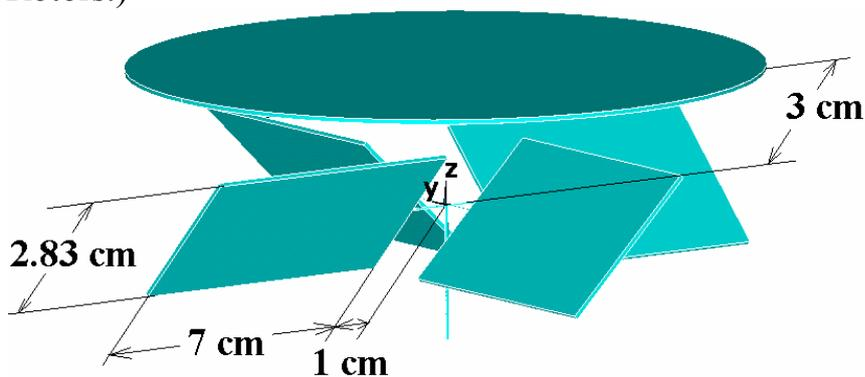
**Abb. 26:** Graphische Veranschaulichung eines supraleitenden Rotors der auf einer Achse unter einem flachen Dauermagneten angebracht ist.
