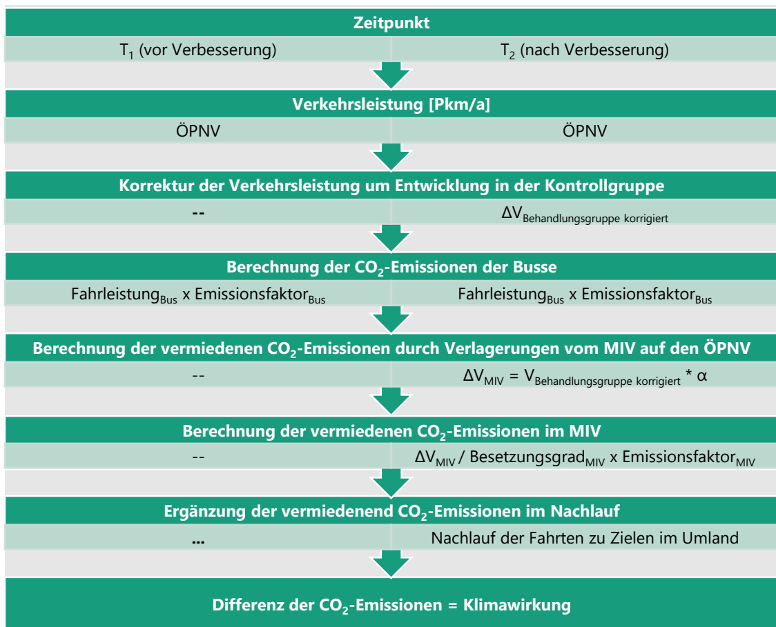
Abbildung 32: Vorgehensweise bei der Berechnung der CO 2 -Emissionen
