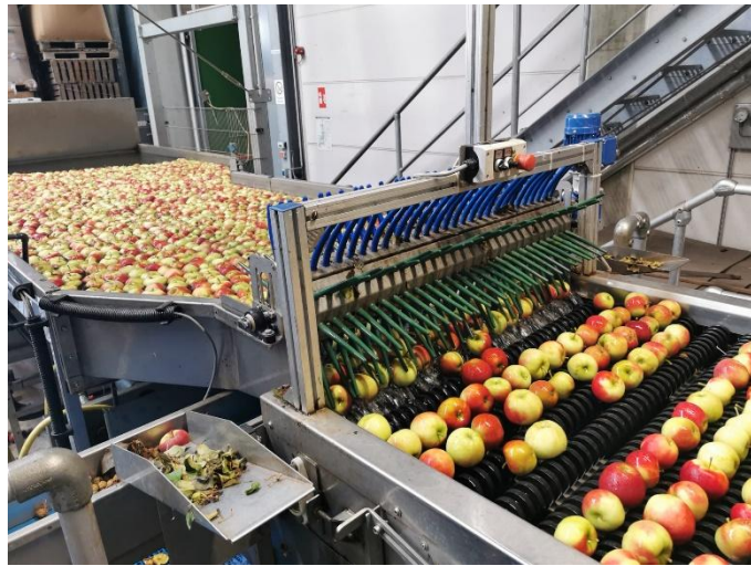
Abb. 3: Die Äpfel werden gewaschen und weiter zur Sortierung geleitet (Meyer zu Erbe, Fried (2025))
