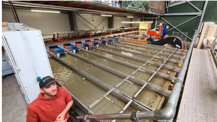
Abb. 8: Betriebsleiter kontrolliert die bildanalytisch arbeitende Sortiermaschine (Horn, Peer (2025))
