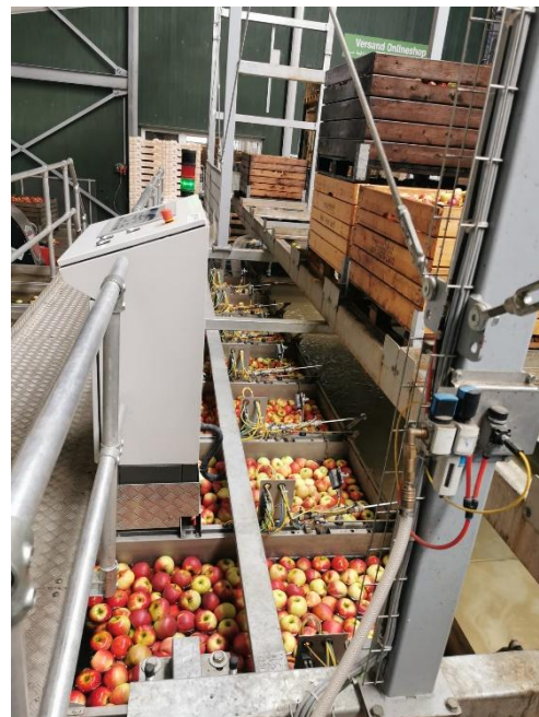
Abb. 4: Äpfel werden maschinell in Kisten verpackt (Meyer zu Erbe, Fried (2025))
