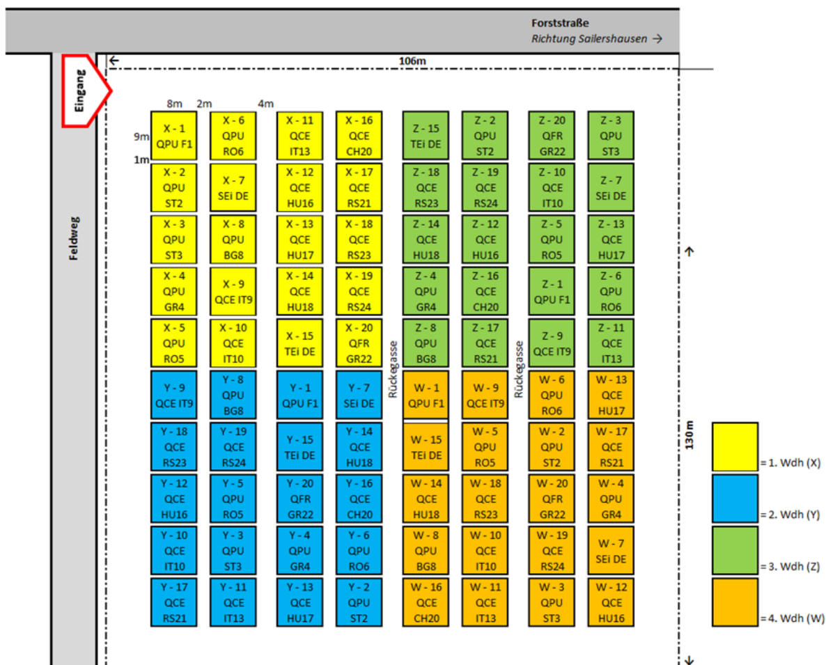
Abbildung 7: Beispiel eines Versuchsaufbaus anhand der Versuchsfläche Sailershausen mit 20 Herkünften (HK) und 4 Wiederholungen (Wdh.). Insgesamt befinden sich auf dieser Fläche 4000 Pflanzen (20 HK x 4 Wdh. x 50 Pfl. pro Parzelle).
