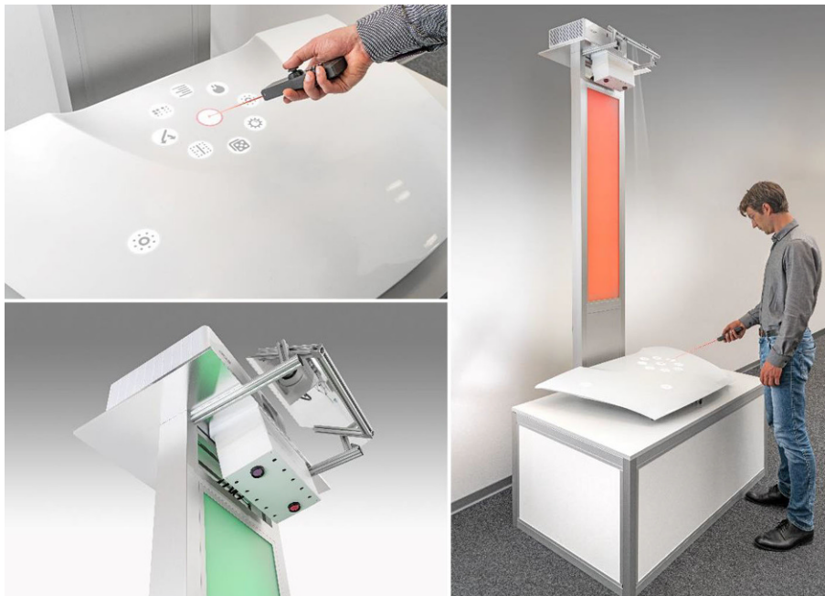
Abb. 1 Mit einem Projektor wird die Bedienführung auf das Bauteil projiziert. Fehler können per Zeigegeste und Spracheingabe oder mit einem Laserpointer dokumentiert werden. Die dokumentierten Fehler werden dreidimensional am digitalen Zwilling des Bauteils gespeichert
