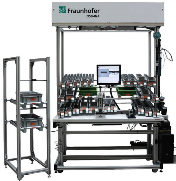
Abb. 3 Ein Montageplatz mit zentralem Bildschirm im mittleren Bereich und Projektor sowie Tiefenkamera für die AR-unterstützung angebracht im oberen Bereich
