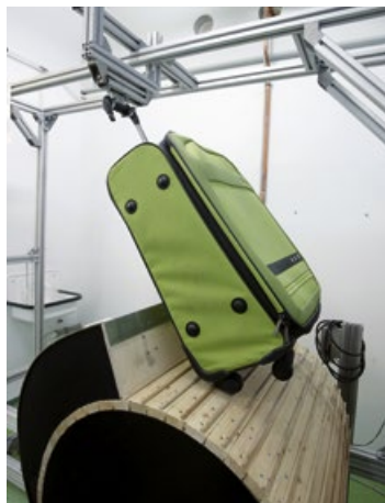
Koffer: Jedes Produkt muss 30 Kilometer auf dem Laufband zurücklegen. Quelle: © Stiftung Warentest.
