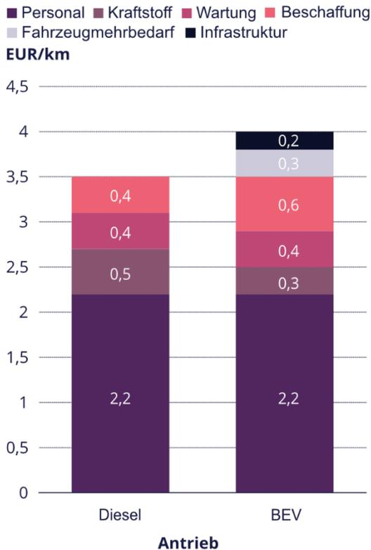
Kostenstruktur für Personenbusse (12 Meter) im ÖPNV nach Antriebsart (Schätzung für 2035). Es werden Kostendegressionen und Fahrzeugmehrbedarfe aufgrund von Ladezeiten angenommen. Kraftstoffkosten basieren auf Mittelfristscenarien (17ct/kWh Strom und 1,2EUR/l Diesel).
