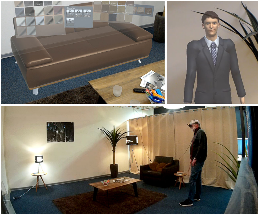
Abb. 2 Unten ist ein Proband gezeigt, der im Möbellabor eine virtuelle Couch platziert hat, welche der Kunde konfigurieren kann ( oben links ). Der Berater ist als Avatar symbolisiert ( oben rechts ) und für den Kunden sichtbar
