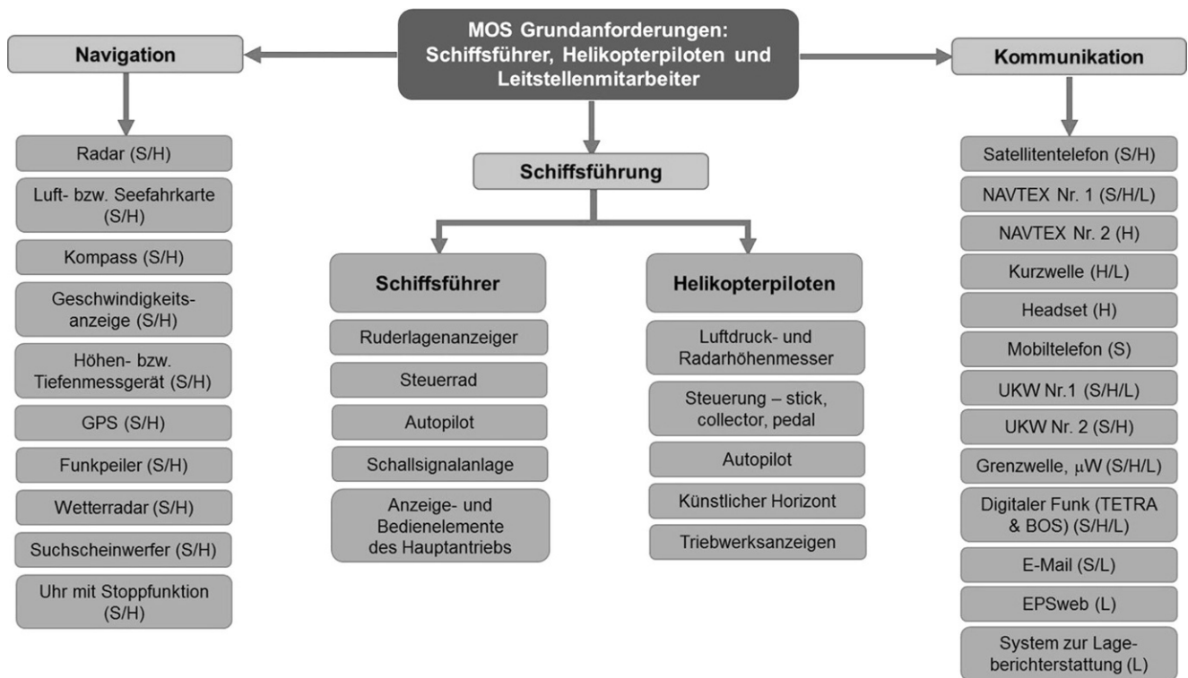
Abb. 4 Grundanforderungen an die MOS über alle Nutzergruppen (S – Schiffsführer, H – Helikopterpiloten, L – Leitstellenmitarbeiter)
