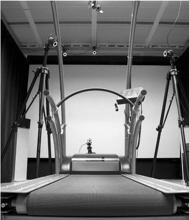
**Abb. 1** Versuchsumgebung mit Laufband und Infrarotkameras
