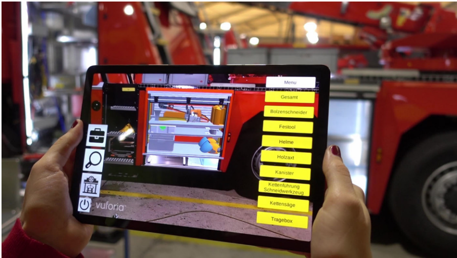
Abb. 7 AR-Anwendung zur Visualisierung des Innenausbaus von Geräteräumen eines Feuerwehrfahrzeugs
