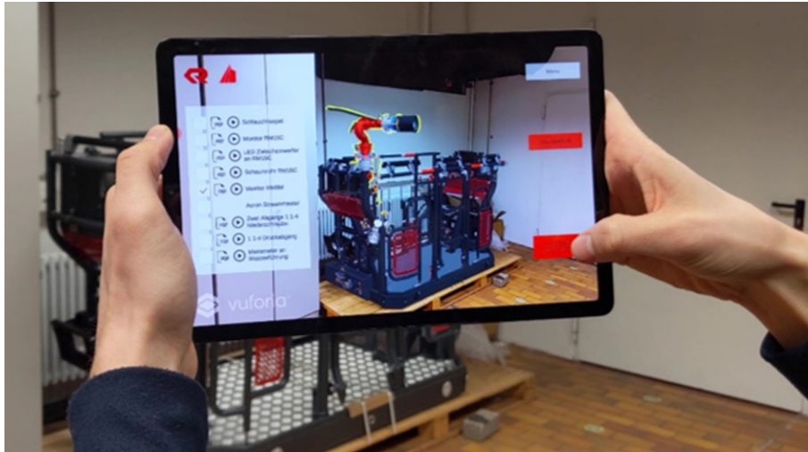
Abb. 5 AR-Funktionen zur Strukturdarstellung und zum Ein-/Ausblenden von virtuellen Daten
