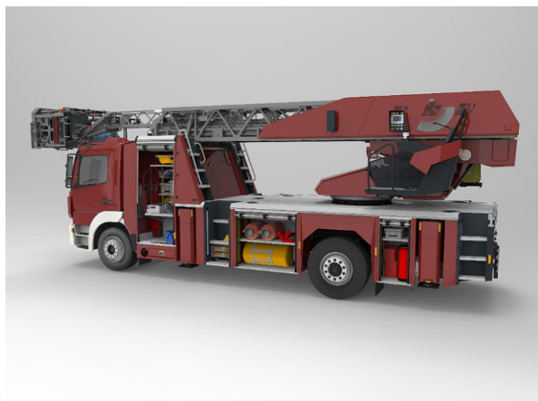
Abb. 6 Geräteräume für Feuerwehrausrüstungen. (Quelle: Rosenbauer)
