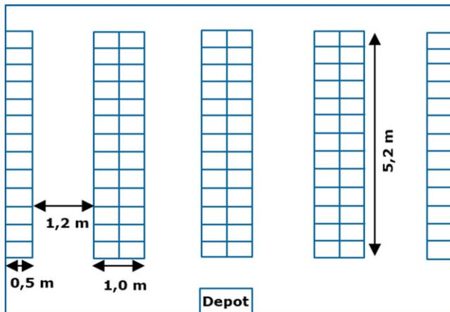
**Abb. 8** Lagerlayout bezüglich der beispielhaften ergonomischen LPV
