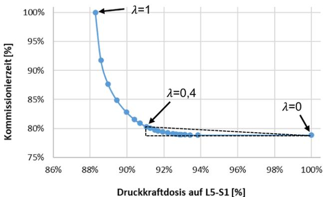
**Abb. 9** Pareto-Kurve des Beispieldatensatzes bei Variation von  $\lambda$
