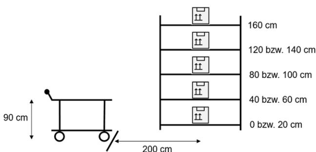
**Abb. 3** Versuchsaufbau zur Identifizierung der Körperhaltung bei Kommissioniertätigkeiten
