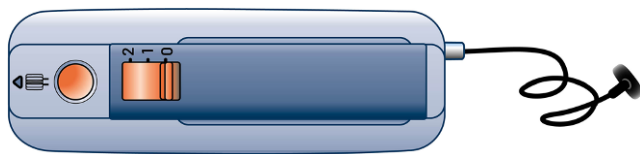
Abb. 4 Form und Lage der Bedienelemente geben Hinweise zum Status und zur Handhabung des Geräts
