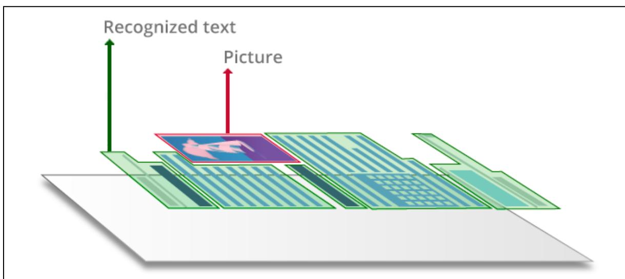
Abbildung 9: Separierte Layer-Architektur in PDFs<sup>22</sup>
