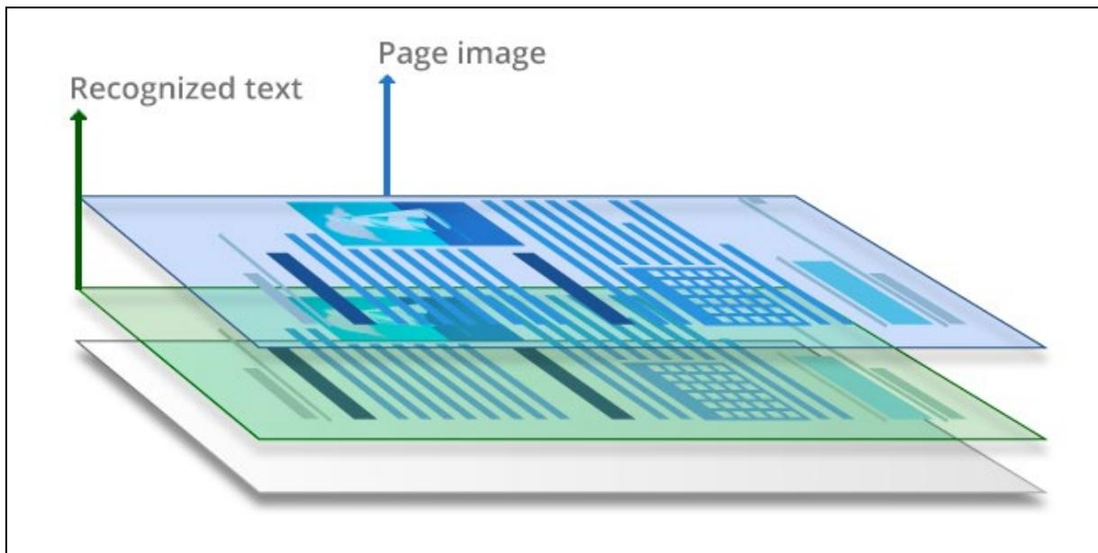
Abbildung 8: kombinierte Layer-Architektur in PDFs<sup>20</sup>
