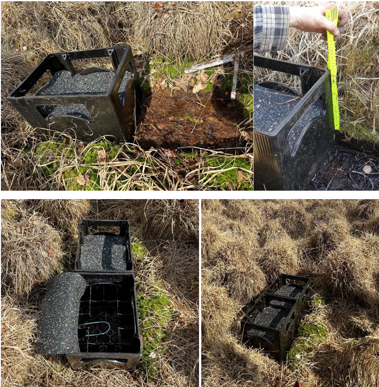
Abbildung 26: Installationsschritte: a) Einpassen der Kisten in präparierte Mulden; b) Messen des Abstandes Oberkante zu Beginn Torfhorizont; c) Verankern der Kiste mittels Krampen; d) Kisten nach Installation
