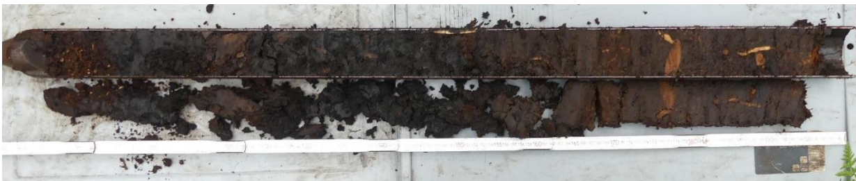
Abbildung 11: Stechbohrer (Firma Eijkelkamp) mit 1 m langem Bohrkern.
