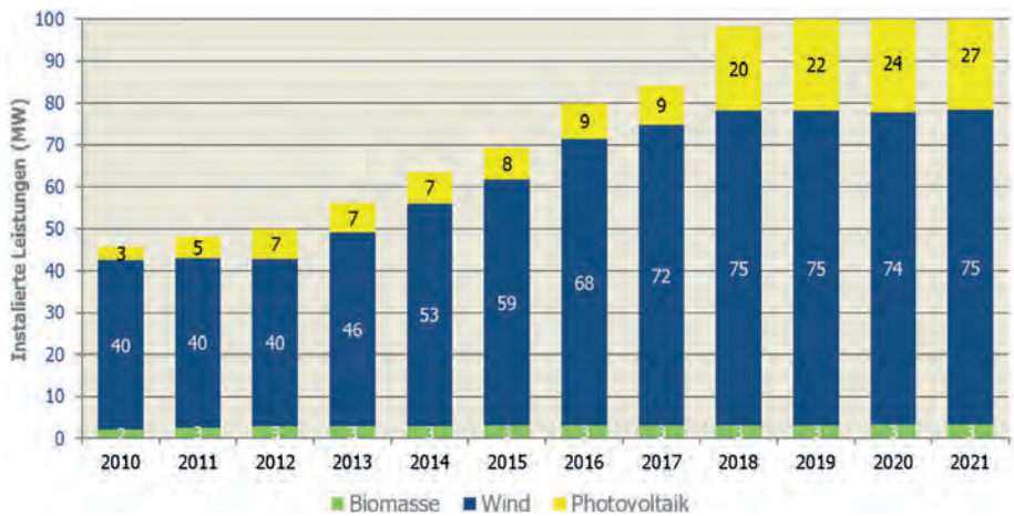
Abb. 7: Leistung der EEG-Anlagen im Stromnetz der Stadtwerke Prenzlau GmbH zwischen 2010 und 2021 / Quelle: Stadtwerke Prenzlau GmbH 2022
