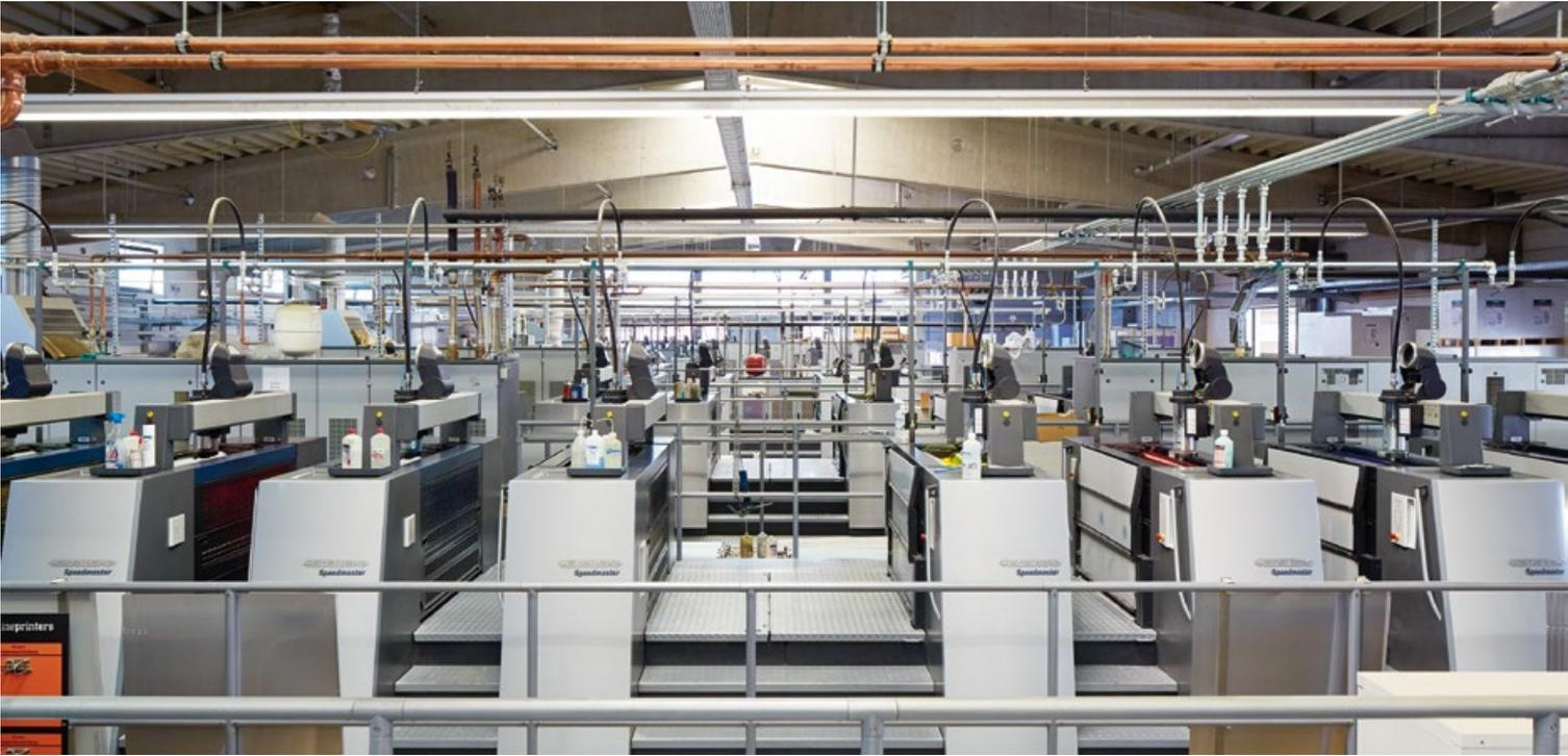
**Beeindruckender Technikpark** mit Acht-Farben-Offsetdruckmaschinen
