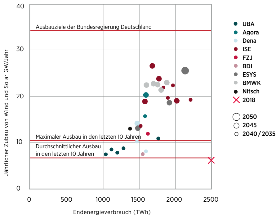
Endenergieverbrauch und jährlich installierte Kapazität von Wind und Solar in unterschiedlichen Klimaneutralitäts-Szenarien (-95% bis -100% THG-Emissionen ggü. 1990) für Deutschland: Jeder Punkt steht für ein Szenario, die Farben sind die Studien/ Autor*innen. Zum Vergleich sind der durchschnittliche Zubau der letzten zehn Jahre und der höchste erreichte jährliche Zubau angegeben.
