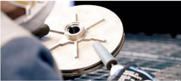
**Nachbearbeitung** eines im SLM-Verfahren additiv gefertigten Pumpenlaufrads.
