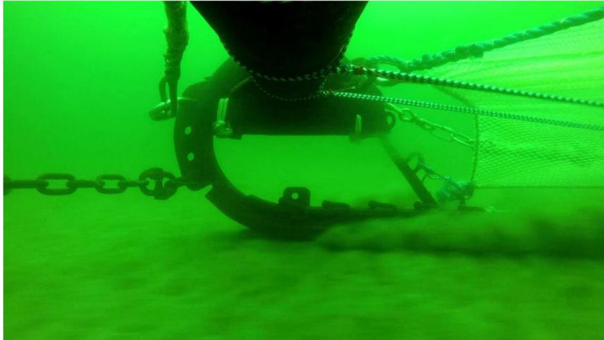
Abbildung 21: Krabbenbaumkurre im Einsatz mit Blick auf äußeren Kurrschuh. Abbildung aus Mieske (2019b) 26 .
