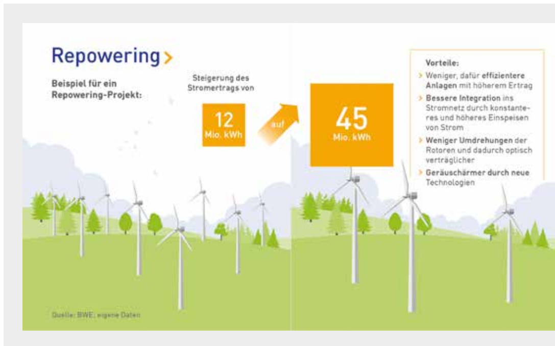
Abbildung 6: Repowering (mit freundlicher Genehmigung von EnBW 106 )
