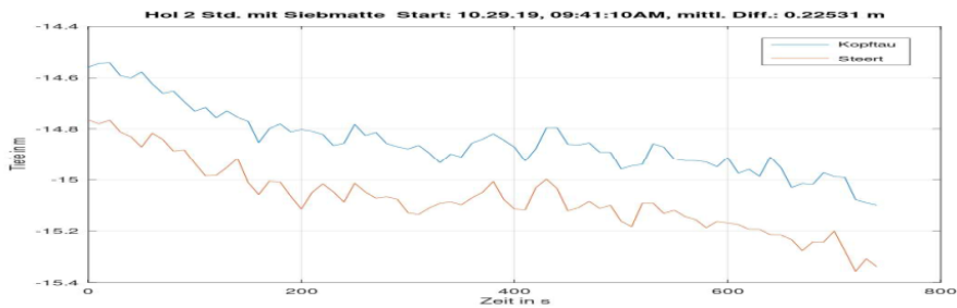
Abbildung 50: Tiefenmessung 2 an der traditionell zugeschnittenen Siebmattenkurre mit abfallendem Seitenkeil Figure 50: Depth measurement no. 2 on the traditionally cut sieve mat beam trawl with sloping side wedge
