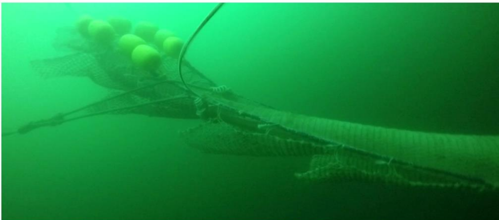
Abbildung 17: leerer Steert mit EVA-Floats mit 40 kgf Gesamt-Auftrieb an den Lashes, sowie einem Hund (Steertboje) aus 2 m Leine und 2 Stck. 28 mm Kugeln mit jeweils 8,2 kgf Auftrieb
