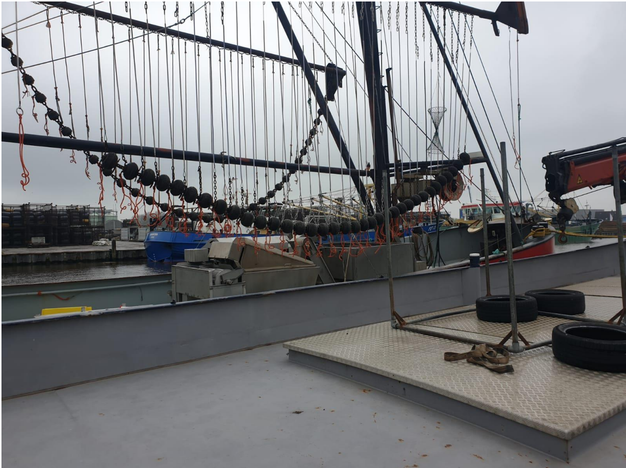
Abbildung 61. Rollengeschirr des niederländischen Fischers Corrie Nagel. Die Rollen sind weiterhin in Schlepprichtung gerade ausgerichtet, das gesamte Geschirr ist aber ausgerundet (Quelle: Pieke Molenaar, Wageningen Marine Research).
