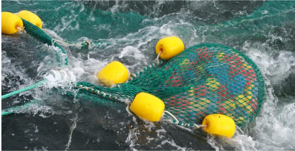
Abbildung 11: Plastik-Topfkratzer (Scheuerpads) als Simulation für den Fang Figure 11: Plastic scouring pads as simulation for the trawl catch
