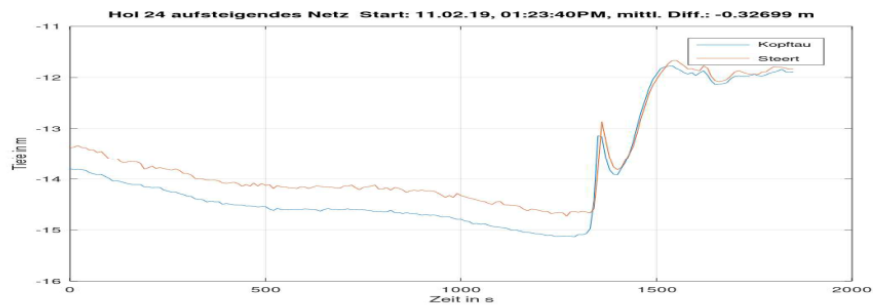
Abbildung 68: Tiefenmessung 3 an der aufsteigend zugeschnittenen Kurre Figure 66: Depth measurement no. 3 at the ascendingly cut beam trawl
