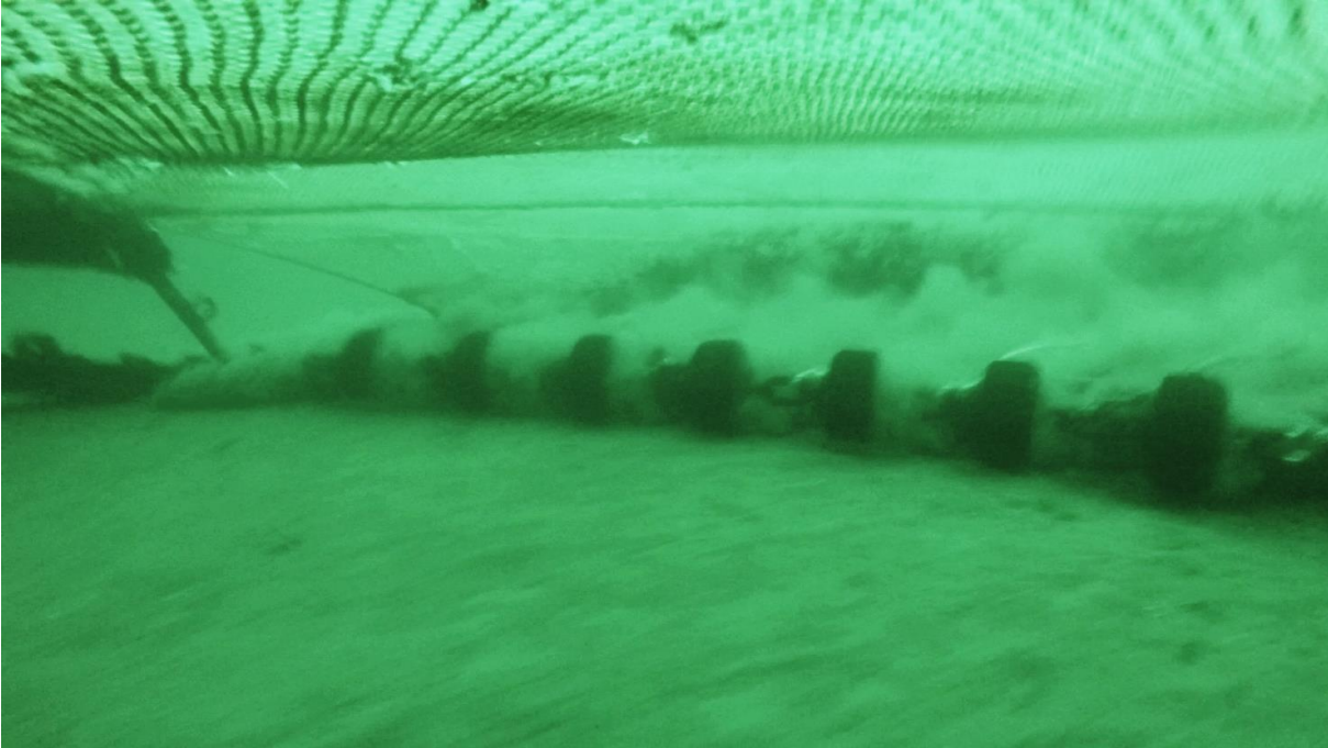
Abbildung 45. UW-Aufnahme vom Grundgeschirr einer Krabbenbaumkurre beim Schleppen. Die seitlichen quer stehenden Rollen verursachen starke Sedimentaufwirbelungen (Aufnahme in der Ostsee).
