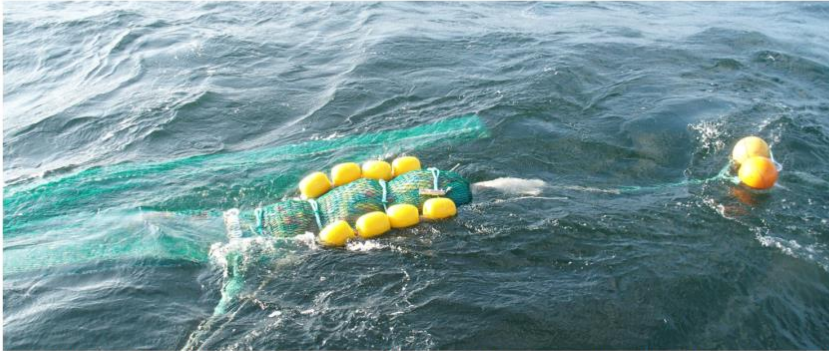
Abbildung 16: Mit 0,5 m 3 Fangimitat gefüllter Steert mit 4 Ringverstärkungen um den Hievsteert, hinter dem Hievstropp EVA-Floats mit 40 kgf Gesamt-Auftrieb an den Lashes, sowie einem Hund (Steertboje) aus 2 m Leine und 2 Stck. 28 mm Kugeln mit jeweils 8,2 kgf Auftrieb
