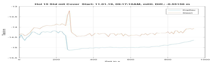
Abbildung 61: Tiefenmessung 5 an der traditionell zugeschnittenen Kurre mit abfallendem Seitenkeil und Auffangsteert unter dem Siebnetzausgang Figure 61: Depth measurement no. 5 at the traditionally cut beam trawl with sloping side wedge and cover codend under the sieve net exit
