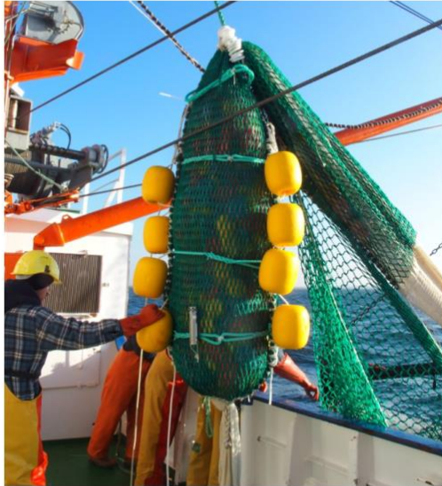
Abbildung 13: Baumkurrensteert mit 4 Ringverstärkungen und Plastik-Fangimitat Figure 13: Beam trawl cod end with 4 ring reinforcements and plastic catch imitation
