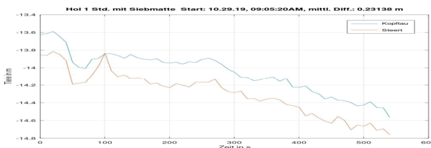
Abbildung 49: Tiefenmessung 1 an der traditionell zugeschnittenen Siebmattenkurre mit abfallendem Seitenkeil Figure 49: Depth measurement no. 1 on the traditionally cut sieve mat beam trawl with sloping side wedge
