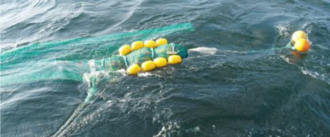
Abbildung 19. An den Steertlaschen angebrachte Auftriebskörper und Schleppboje.
