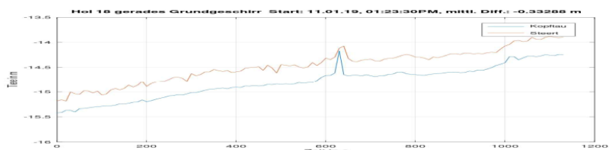
Abbildung 64: Tiefenmessung 2 an der Kurre mit neutral zugeschnittenem Seitenkeil und geradem Rollentau Figure 64: Depth measurement no. 2 at the beamtrawl with neutral cut side wedge and straight roller rope
