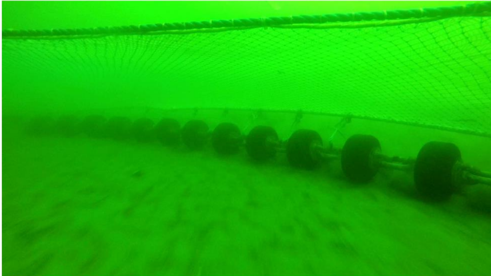
Abbildung 13: Die obere Siebmatten-Spannleine wurde am Kopftau durchgehend befestigt, die Siebnetzseiten wurden an einer Fischleine aufgefädelt, die untere Spannleine ist entnommen. Das Grundtau befindet sich zu weit über dem Rollentau.
