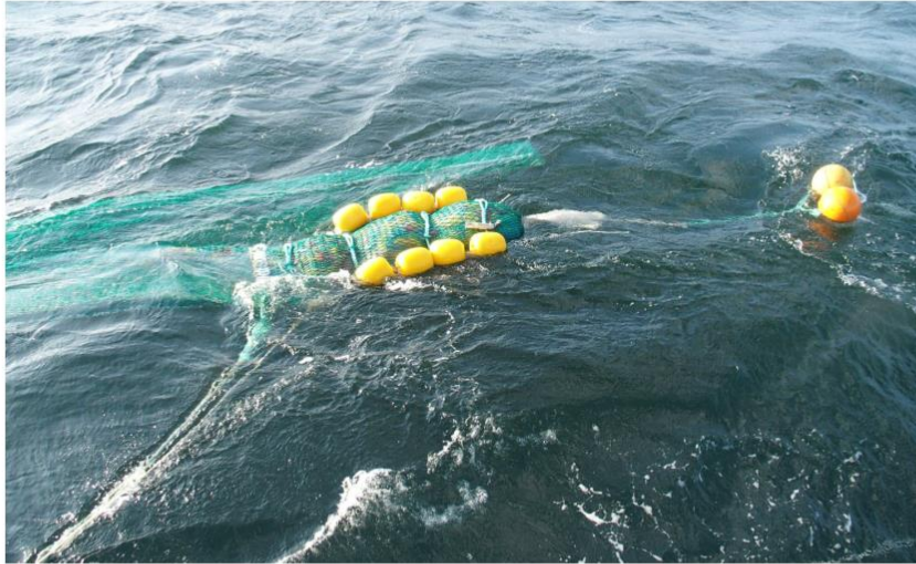
Abbildung 1: EVA-Floats mit 40 kgf Auftrieb, Ringverstärkungen und Steertboje am Steert einer Baumkurre
