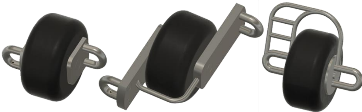
Abbildung 50. Verschiedene Konzepte/Modelle achsversetzter Rollen. Links: geringer Achsversatz. Mitte: großer Achsversatz mit unterstützendem Bügel. Rechts: Früher genutzte Von-Holdt-Rolle, die eine Einstellung des Achsversatzes erlaubt. Grafik: Thünen/Uwe Lichtenstein
