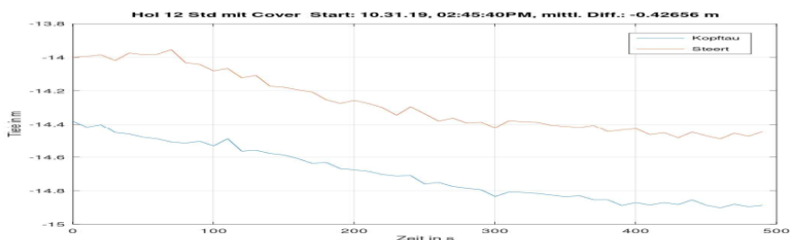
Abbildung 58: Tiefenmessung 2 an der traditionell zugeschnittenen Kurre mit abfallendem Seitenkeil und Auffangsteert unter dem Siebnetzausgang
