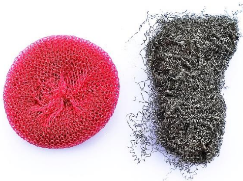
Abbildung 9. Simulation des Fanggewichts mit Plastik-Topfreinigern (oben und unten, jeweils links) und Edelstahl-Topfreinigern (oben und unten, jeweils rechts). Fotos: Thünen
