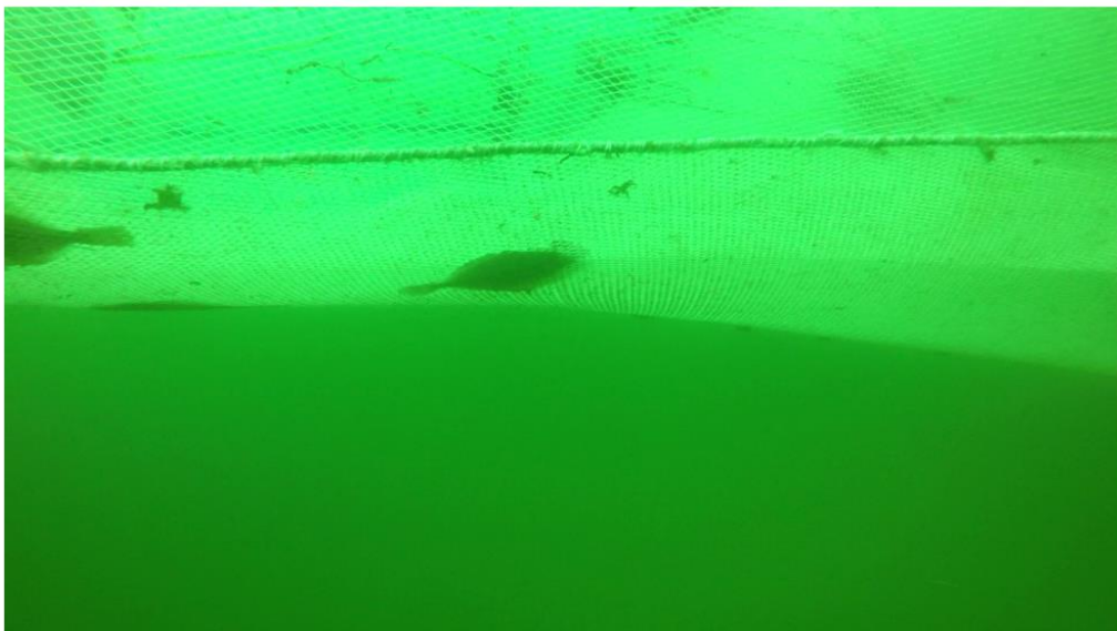
Abbildung 27: Blick auf die infolge der Beschwerung stärker abfallende Linie des Auffangnetzes Figure 27: View of the line of the cover cod end net dropping more steeply as a result of the weighting
