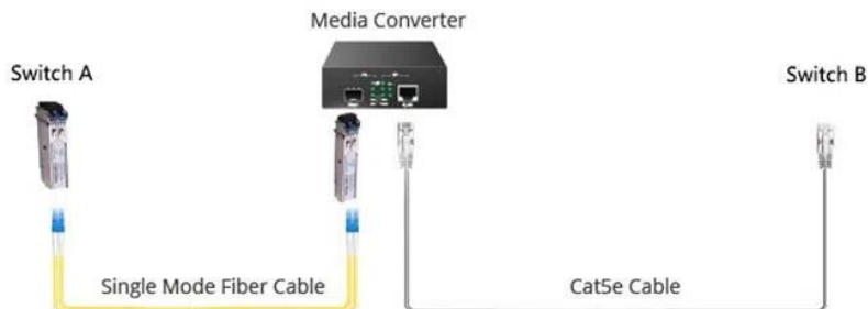
Abbildung 3-9: ‚Stand-alone‘ Anwendung von SFP-Modulen (optischen Transceiver) für die Verbindung von zwei Ethernet Switches über ein Singlemode-Faserkabel und Cat5e-Kabel
