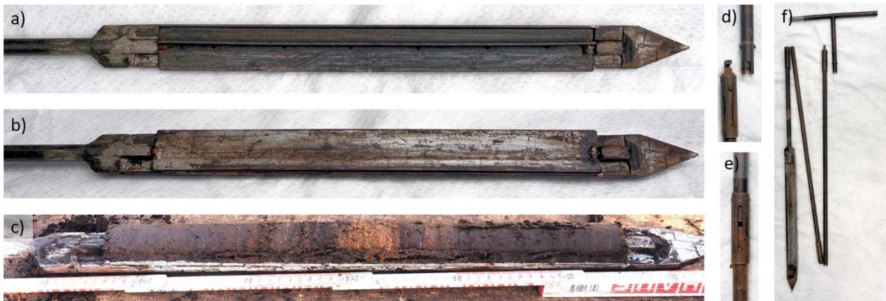
Abbildung 5: a) geöffnete Klappsonde, b) geschlossene Klappsonde, c) Klappsonde mit Bodenprobe, d) und e) Verschlussmechanismus für Verlängerungsstangen und f) Klappsonde mit Verlängerungen und Griff
