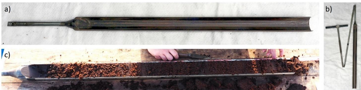
Abbildung 4: Ein Meter langer a) Stechbohrer, b) mit Verlängerung und Griff und c) mit Bodenprobe
