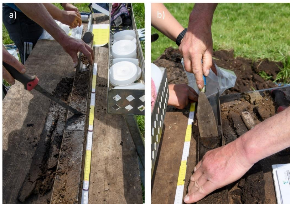
Abbildung 16: a) Horizontabgrenzung innerhalb des ersten Meters einer mit dem Stechbohrer entnommenen Probe und b) Überführung der Probe aus dem Stechbohrer in eine Plastiktüte
