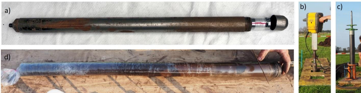
Abbildung 6: a) Rammkernsonde (Schlauchsonde) mit Hülse und Schlauch, b) Elektrohammer, c) Ziehhilfe und d) Bohrkern
