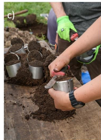
Abbildung 8: a) Vertikale Beprobung des obersten Horizontes mittels Stechzylinder, b) Ausgraben der eingeschlagenen Stechzylinder und c) Säuberung der entnommenen Stechzylinder
