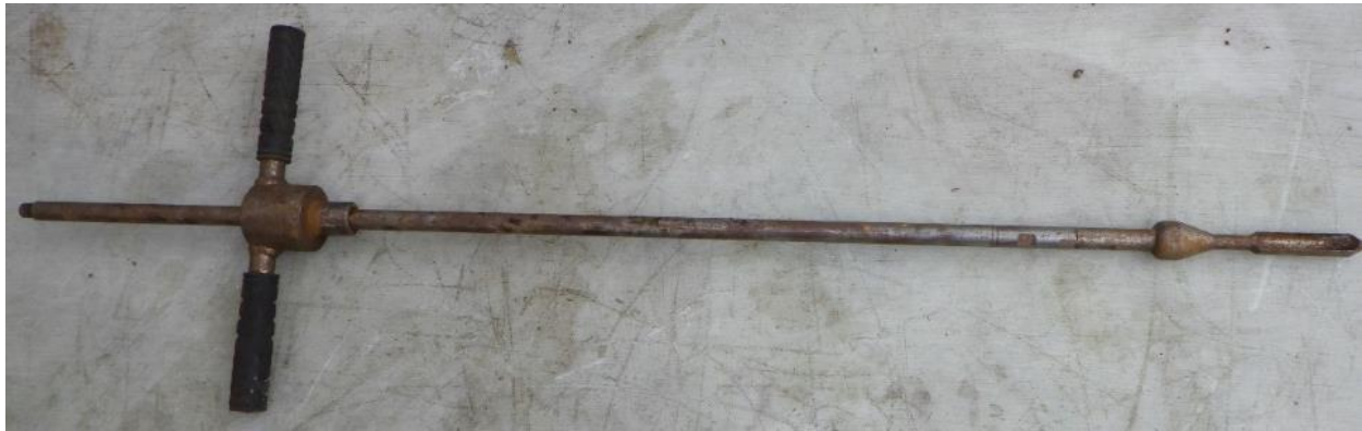
Abbildung 17: Moorpeilstange mit beweglichem Griff und konisch zulaufender Spitze
