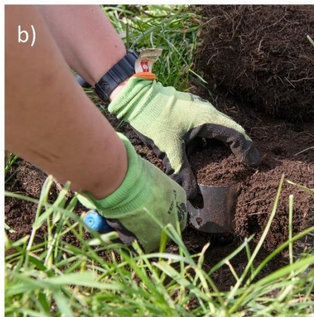
Abbildung 8: a) Vertikale Beprobung des obersten Horizontes mittels Stechzylinder, b) Ausgraben der eingeschlagenen Stechzylinder und c) Säuberung der entnommenen Stechzylinder
