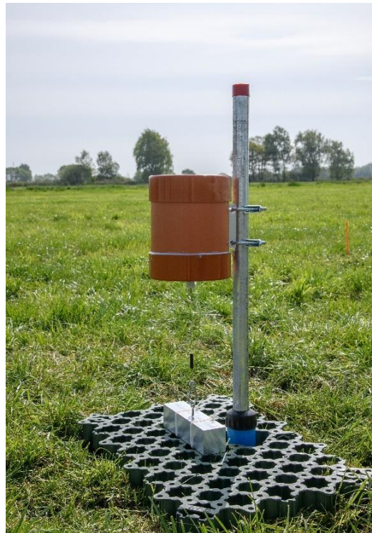
Abbildung 32: An der Fixstange installierter Seilzugsensor mit Rasengitterstein und Aluminiumblock
