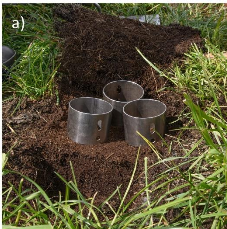
Abbildung 8: a) Vertikale Beprobung des obersten Horizontes mittels Stechzylinder, b) Ausgraben der eingeschlagenen Stechzylinder und c) Säuberung der entnommenen Stechzylinder
