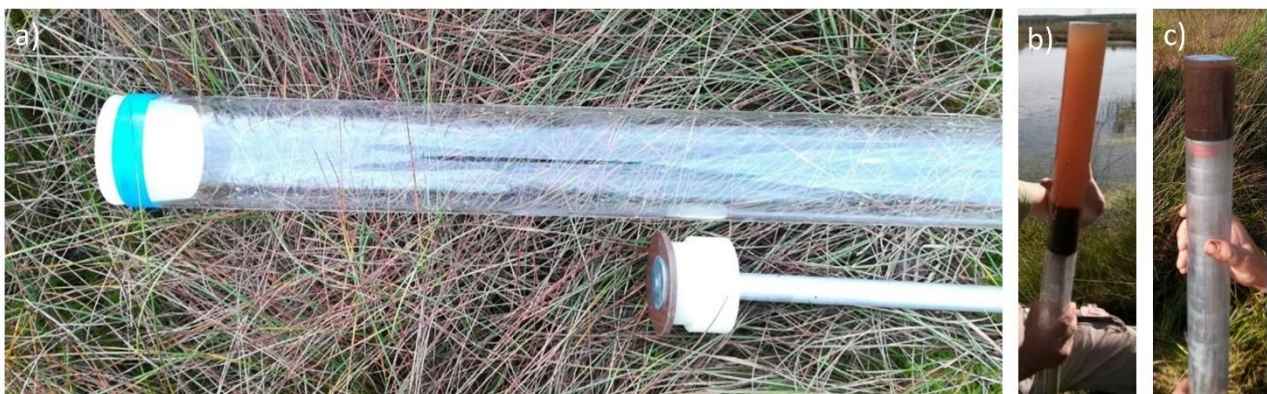
Abbildung 12: a) Sediment-Probennehmer (Plexiglasrohr) mit Stopfen und Stempel, b) Probe mit überschüssigem Wasser und c) Muddeprobe
