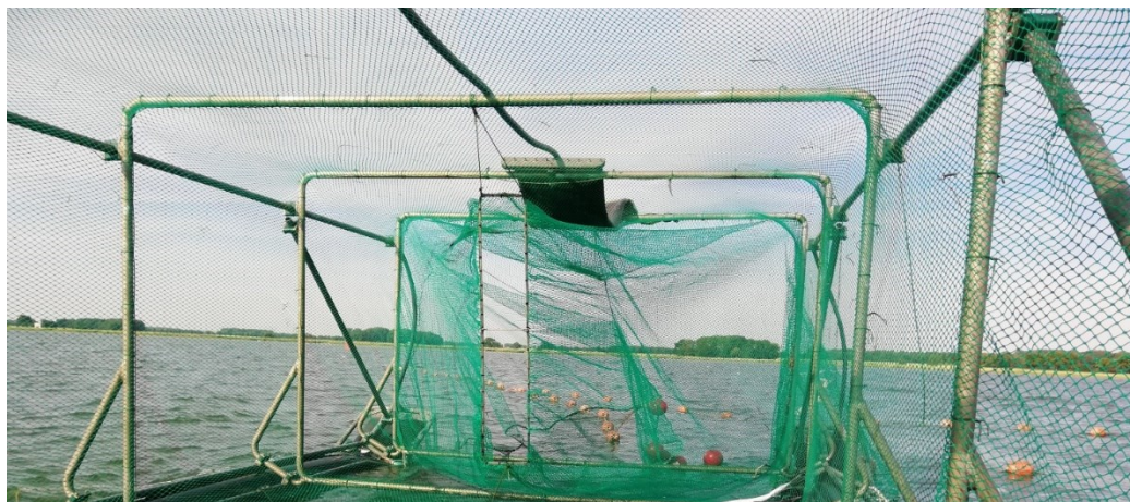
Abbildung 28: Ponton-Hebereuse. Fangkammer mit Einlass und Robben-Excluder (vertikaler Rahmen). Blick von innen.
