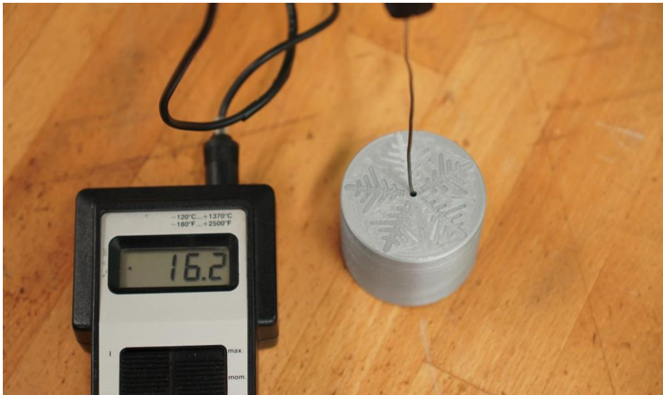
Abbildung 2: Experimentiersetting zur Wärmedämmung
