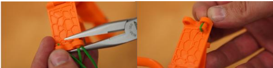
Abbildung 40: Montage der Gummibänder für die Handanbindung
