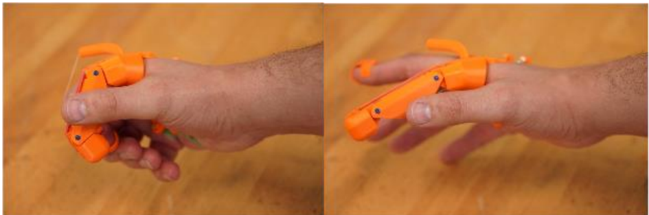
Abbildung 42: Funktionsweise des fertiggestellten bionischen Fingers
