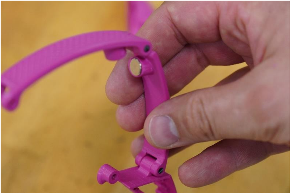
Abbildung 19: Montage der Magnete
