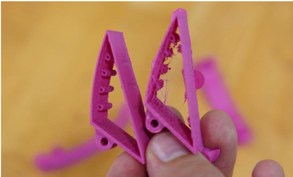
Abbildung 18: Vergleich: bearbeitete (links) und unbearbeitete (rechts) Fin Ray
