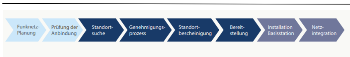
Abbildung 2-1: Schritte beim Aufbau einer Mobilfunk-Basisstation
