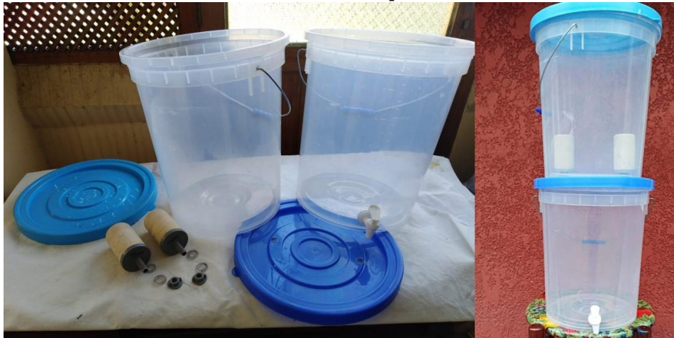
Gráfica 6. Filtro de Cerámica diseñado para la comunidad de Tarvita
