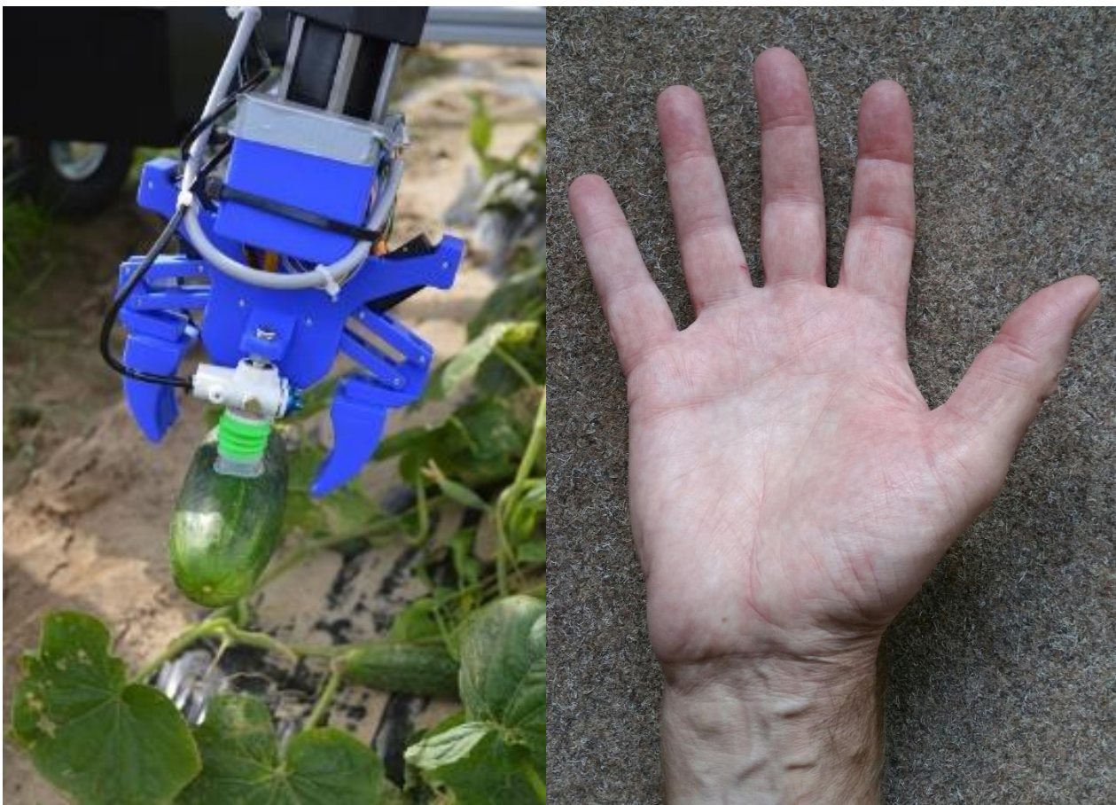
Abbildung 3: Greifer für die Einlegegurkenernte im Vergleich mit der menschlichen Hand
