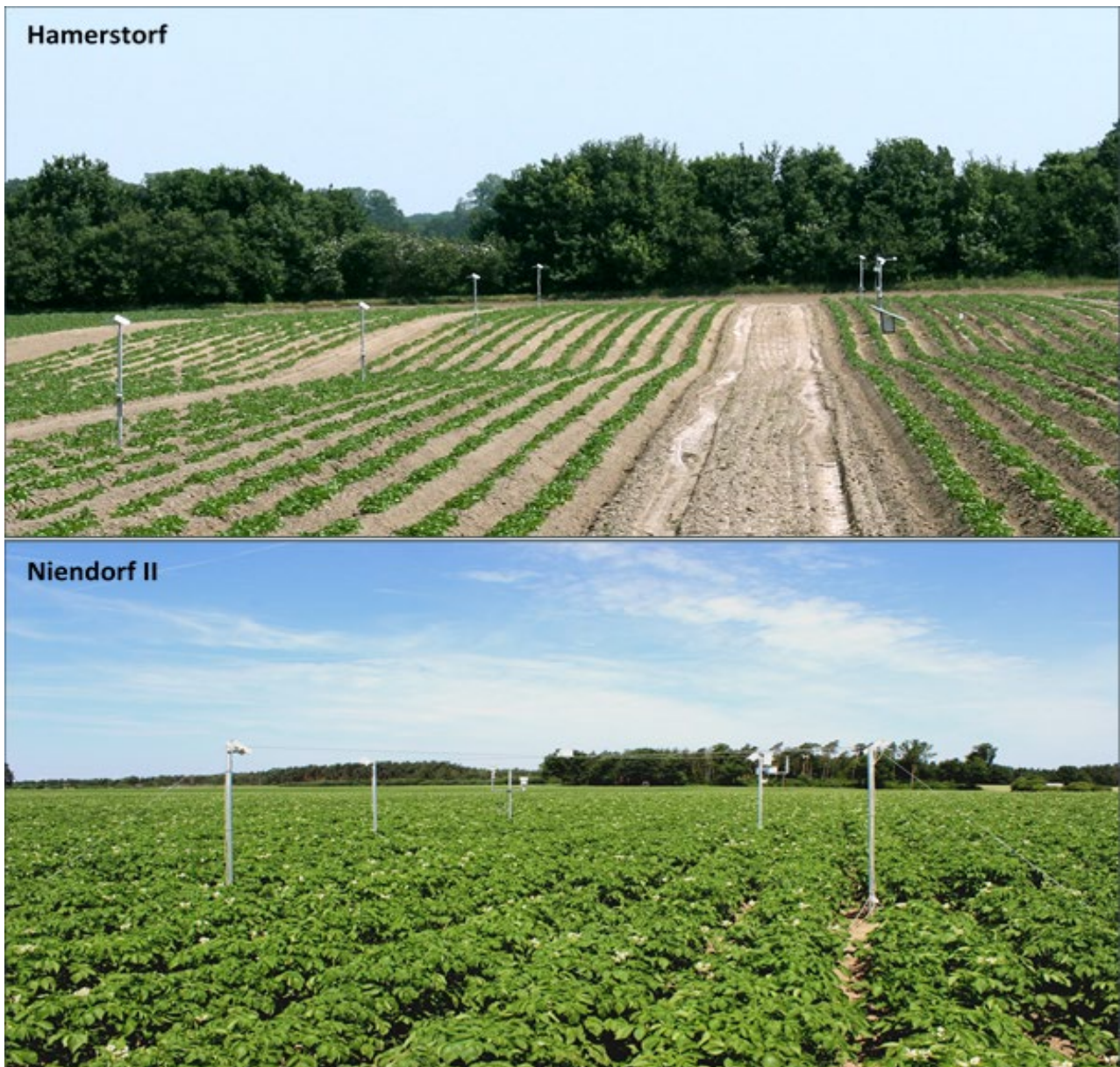
Abbildung 3-2: Aufbau der Messstationen im SeBeK-Versuch: In Reihe aufgebaute Sensorik am Standort Hamerstorf (oben), ausgestattet mit sechs zum Bestand ausgerichteten Infrarotsensoren und meteorologischen Messgeräten. Unteres Foto: kreisförmiger Messaufbau am Standort Niendorf II, ausgestattet mit vier schräg und einem senkrecht zum Bestand ausgerichteten Infrarotsensoren sowie meteorologischen Messgeräten. Fotos: Thünen-Institut (2018; 2019).
