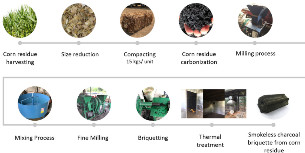
Fig. 1. Smokeless charcoal production chain.
