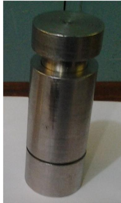
**Plate 2.4.** Punch and die (Manual briquetting machine).
